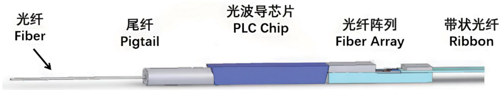
PLC 光分路器中 PLC 芯片与 FA 自动耦合封装
